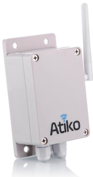
AtikoLRI – это устройство, которое используется для подключения различных измерителей, счётчиков, датчиков и др. к сети Internet по радиоканалу передачи данных. Устройство имеет исполнение IP63 и может работать в температурном диапазоне от -40 до +60°C.
