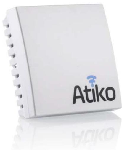
AtikoEI – устройство для контроля состояния воздуха – температура, влажность, давление и уровень углекислого газа – и дальнейшей передачи этой информации по радиоканалу. Устройство имеет степень защиты IP30 и выпускается в двух исполнениях:
